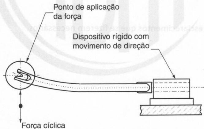
**Figura 3 – Ensaio de fadiga do garfo**
