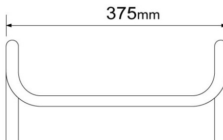
Figura 2 – Dimensões de guidão speed de bicicleta de uso adulto.
